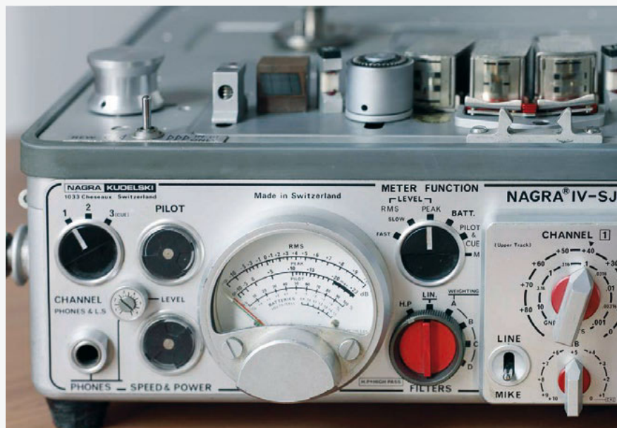
Detail der Attenuatoren, der Anzeigeeinstellungen und des Doppelzeigerinstrumentes
