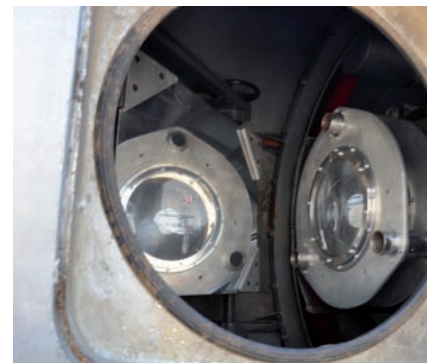
Objektiv und Spiegel in der Nase des Projektors
