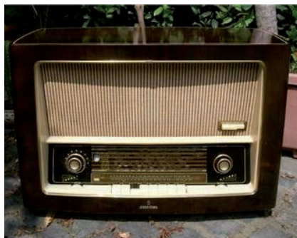
SIEMENS-SUPER H64 von 1954-55 Tuner FM 2x EC92 + ECH81 + 2x MF (EF89 + EF80) + EABC80 + EL84 + EM80
