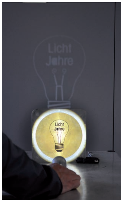
Funktion der Projektion des Spotlights: Lichtquelle beleuchtet Schablone.
