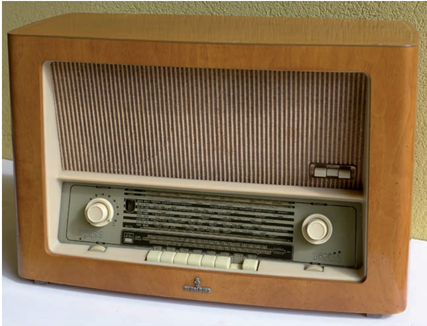
SIEMENS-SUPER H64 von 1954-55 Tuner FM 2x EC92 + ECH81 + 2x MF (EF89 + EF80) + EABC80 + EL84 + EM80
