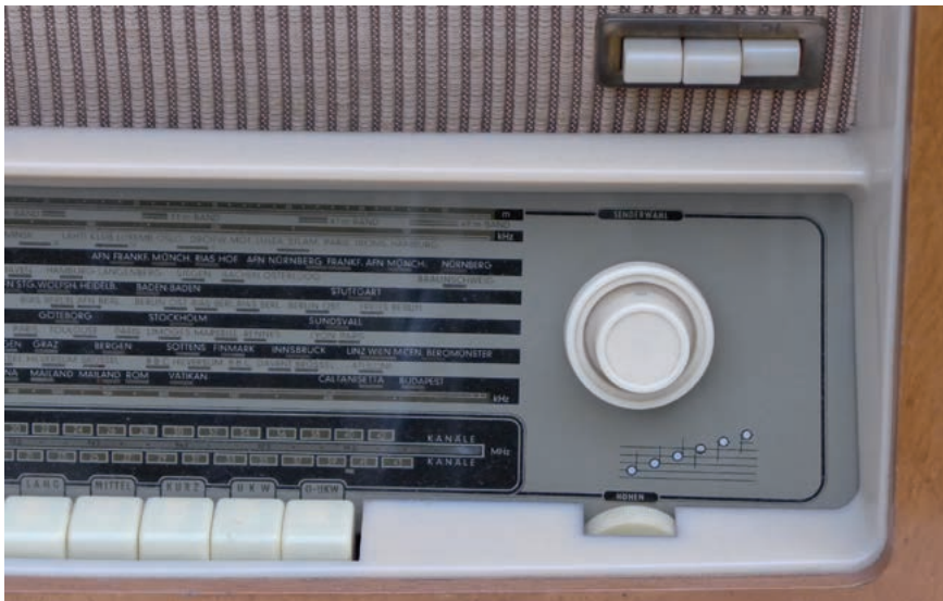
Drei Tasten auf der Frontansicht ermöglichen 4 Raumtonregister: mit der rechten Taste: 5 Lautsprecher für grosse Orchester oder Jazz; mittlere Taste: 3 L. für kleinere Orchester oder Kammermusik; linke Taste: 1 L. für Sprachwiedergabe oder Gesangssoli; keine Taste gedrückt: Instrumente
