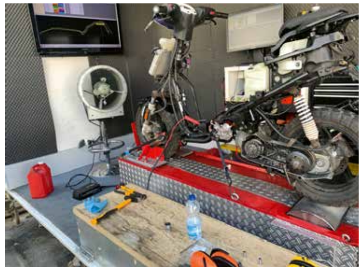
Abbildung 3: Versuchsaufbau mit Roller auf dem Leistungsprüfstand eingespannt
