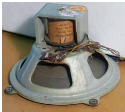
Bild 4: Lautsprecher mit Membran von 18 cm Durchmesser
