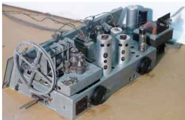
Bild 1: Hinteransicht von Chassis, man sieht die beiden Trafos ZF
