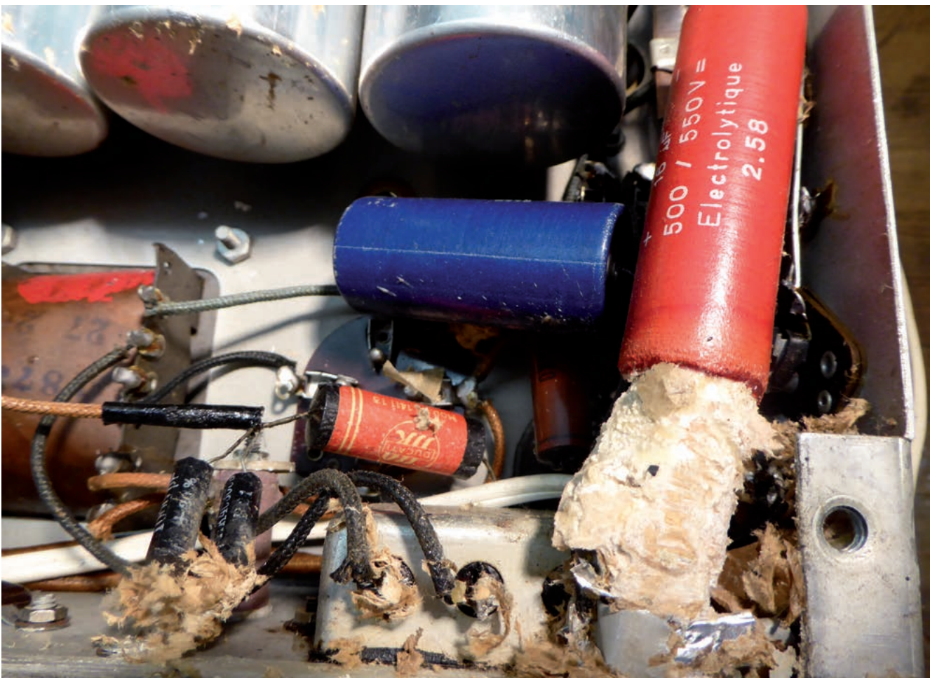
Auf den beiden Bildern ist ein «explodierter» Elektrolytkondensator zu sehen. Er verschmutzte das Chassis und verursachte einige Kurzschlüsse. Glücklicherweise hat der Netztrafo und die Gleichrichterröhre den Härtetest überstanden!
