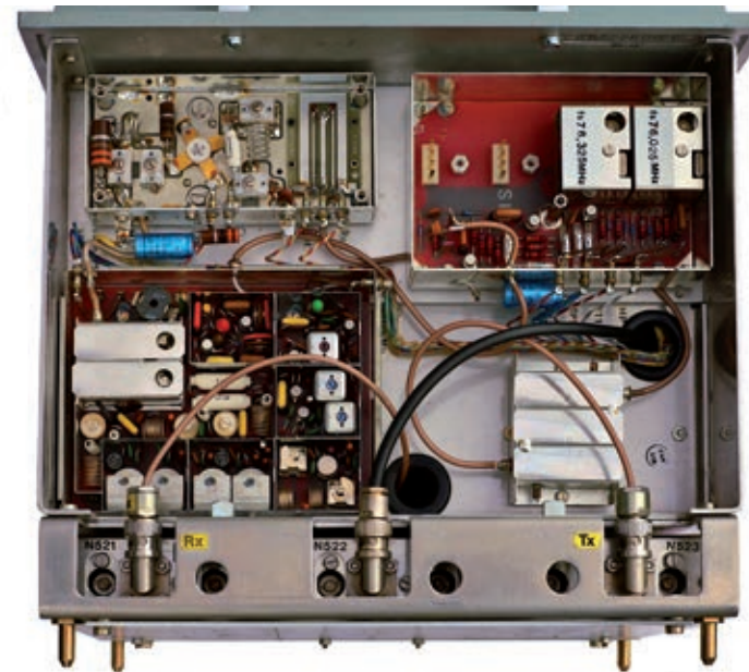
Bild 6: RT24 Sender, komplett. Module ohne Deckel
