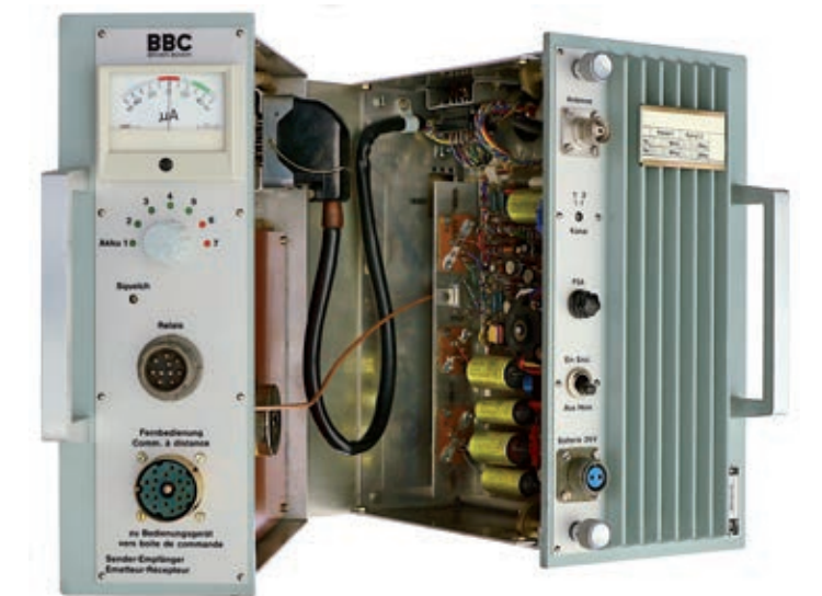
Bild 9: RT24 Funkgerät, aufgeklappt. Rechts S-Teil mit DC-Wandler
