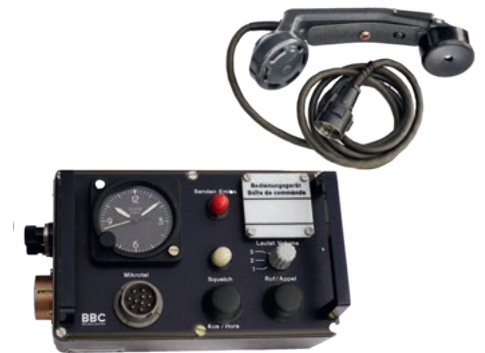
Bild 7: RT24 Bediengerät, Mikrotelefon
