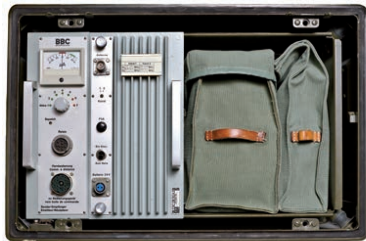
Bild 5: RT24 (SE-221) Sprechfunkstation
