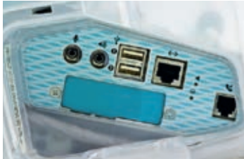
Abb. 5 USB Anschlüsse im iMac G3
