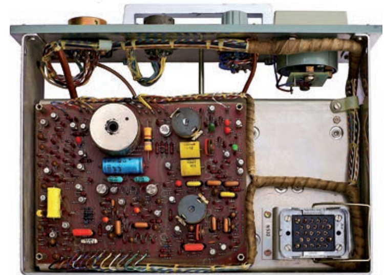
Bild 8: RT24 E-Teil, Audio-/Steuerprint und Messeinheit
