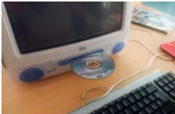
Abb. 3 iMac G3 mit Einzugslaufwerk
