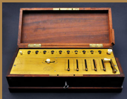
Bild 3: Thomas-Arithmometer (1863) aus der Sammlung Sternwarte der ETH-Bibliothek: erste erfolgreiche, in Serie hergestellte Rechenmaschine der Welt, erfunden von Thomas aus Colmar, Versicherungsunternehmer in Paris. © Herbert Spühler, Stallikon
