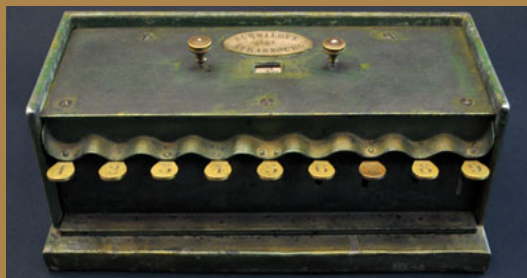
Bild 2: Schwilgué-Tastenaddierer (1851) aus der Sammlung Sternwarte der ETH-Bibliothek: besterhaltene, älteste Tastenaddiermaschine der Welt, erfunden von Schwilgué, dem Schöpfer der derzeitigen astronomischen Uhr des Strassburger Münsters, © Herbert Spühler, Stallikon
