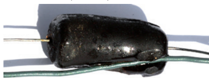
Bild 7: Der «hauptschuldige» Papierkondensator.
