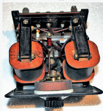
Transformator-Verstärkung im Telefunken Epsilon aus dem Jahr 1925 [Bild: Archiv Michael Roggisch]
