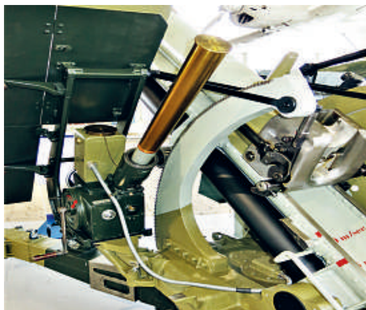
Die Patrone ist 1m lang, steckt neben der Kanone im Tempier-Apparat, der vom Rechner laufend die aktuelle Flugzeit erhält.
