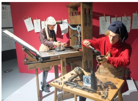
Einzelbuchstabenguss, die eigentliche Erfindung Gutenbergs. Im Hintergrund die Presse Gutenbergs
