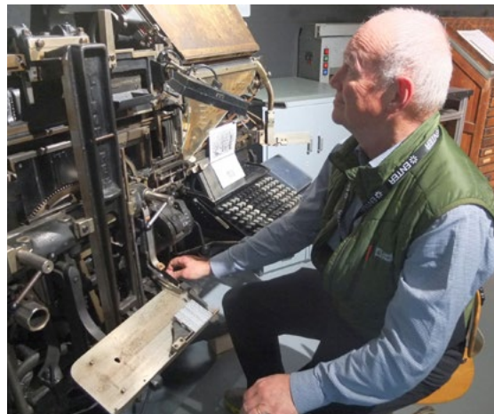
Guy Flüeli an der Linotype, Typ Simplex, Baujahr 1919, die er selbst wieder in Schuss gebracht hat
