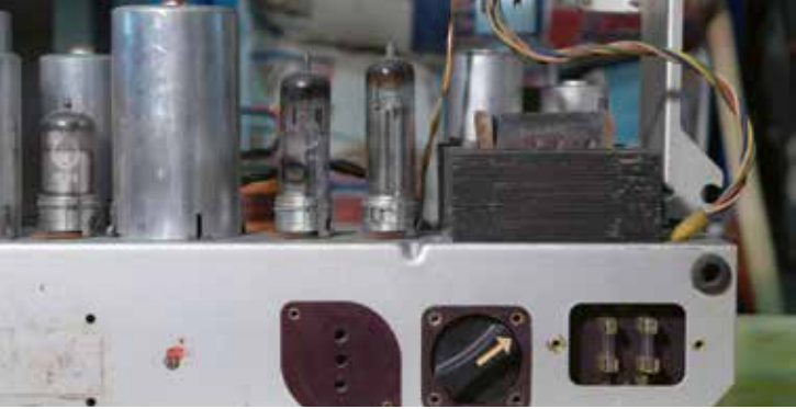
Abb. 6 Auf der Rückseite (v.r.n.l.) befindet sich ein direkter Zugang zu den Sicherungen und dem Schalter zur Auswahl der Netzspannung.
