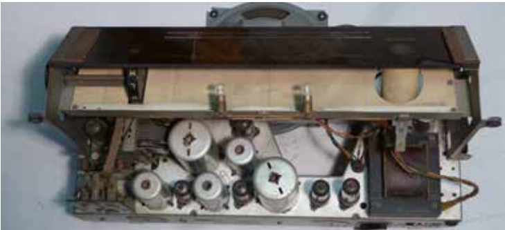
Abb. 2 Das Chassis von oben zeigt die beiden grossen ZF-Transformatoren und die Rimlock-Röhren von 1948 – 50.
