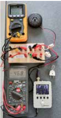
Fig. 1: Messanordnung für die a/b-Schnittstellen
