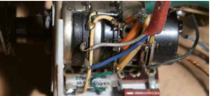
Abb. 5 Der Lautstärkereglер dient als Schalter, indem man seinen Knopf zieht oder drückt, und ist mit zwei Potentiometern zur Korrektur der tiefen und hohen Töne verbunden.
