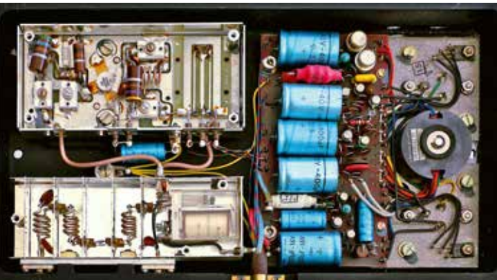
Bild 3: 160MHz/20W VHF-Verstärkereinheit, Abschirmbleche entfernt.
