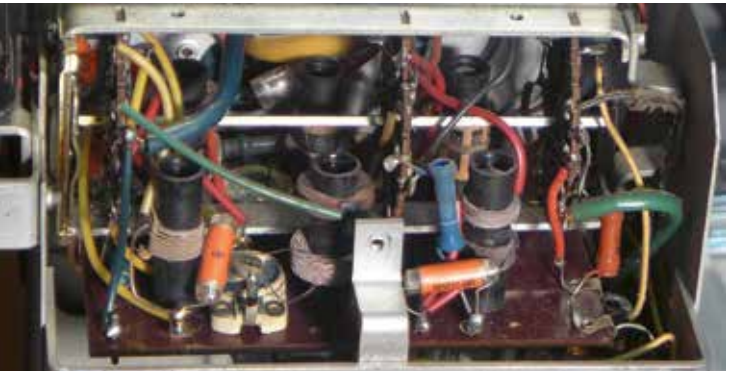
Abb. 4 Der Wellenbereichsschalter besteht aus 3 Ebenen und 6 Spulen mit einstellbaren Kernen, alles in einem abgeschirmten Gehäuse, hier mit offenem Deckel.
