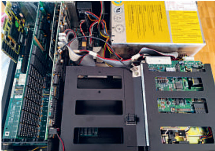
Abbildung 2: Das Innenleben eines IBM PC/AT ohne Festplatte
