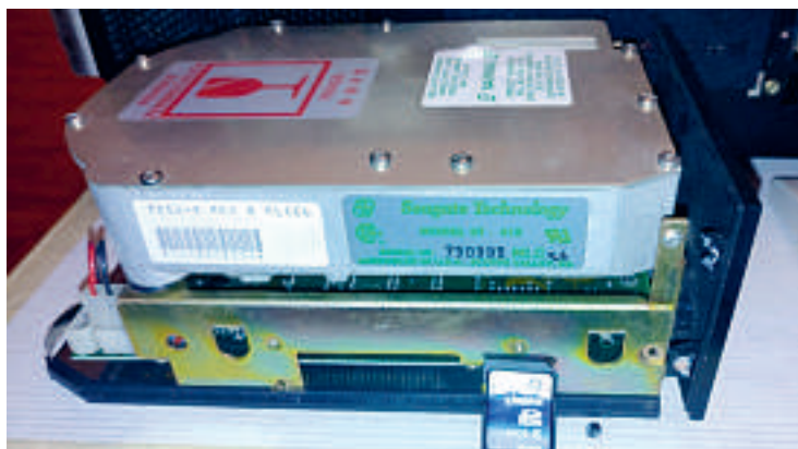
Abbildung 3: Die Seagate ST-412 (10 MB) im Grössenvergleich mit einer SD-Karte (16 GB)
