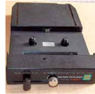
Bild 3: Adapter für die Verwendung von Kompakt Kassetten in einem 8-track Player. Bild freundlicherweise von René Fankhauser, radiomuseum.org zur Verfügung gestellt
