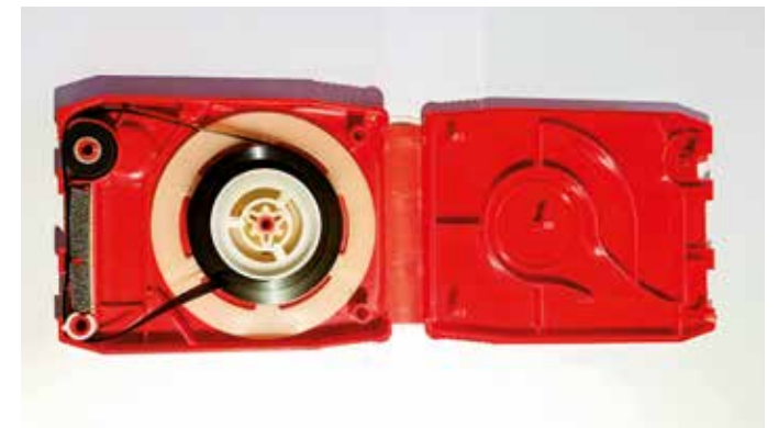
Bild 5: Geöffnete 8-Track Cartridge, links sieht man den Schaumstoffpad und die Gummirolle
