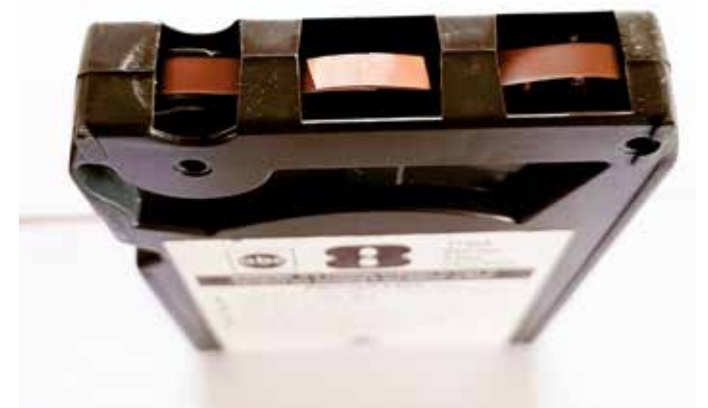
Bild 6: In der Mitte des Tapes ist das Schaltband zu sehen
