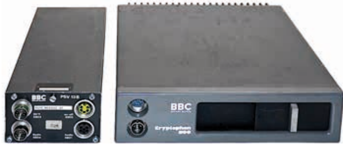
Bild 4: Cryptophon 1100 (SV11) mit Interfacebox PSV13 ©MB
