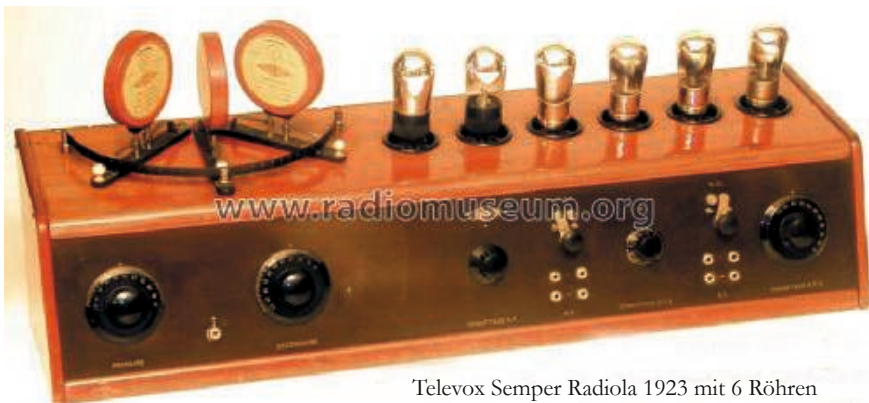
NF-Verstärker Televox von 1923 mit 6 Röhren
