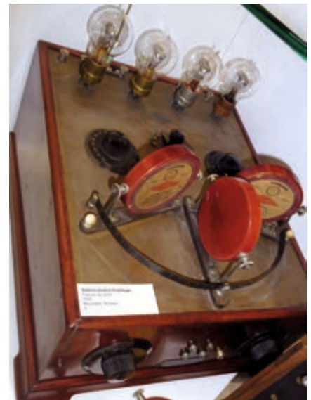
Televox Batterie-Röhrenempfänger mit 4 Röhren 1924
