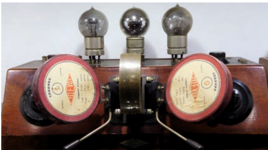
Televox Batterie-Empfänger mit 3 Röhren 1925
