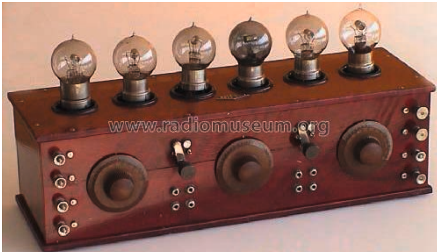
NF-Verstärker Televox von 1923 mit 6 Röhren
