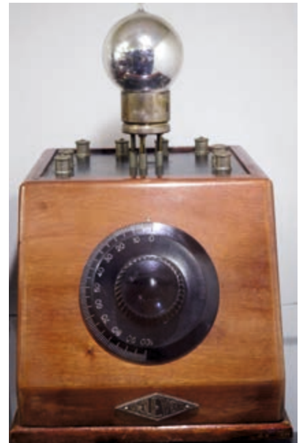
NF-Verstärker Televox von 1923 mit 1 Röhre
