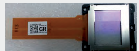
Bild 12b: Das Display eines modernen LCD Beamers (Baujahr unbekannt)
