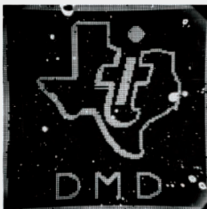
Bild 15: DMD 128x128 Pixel von TI, 1981
