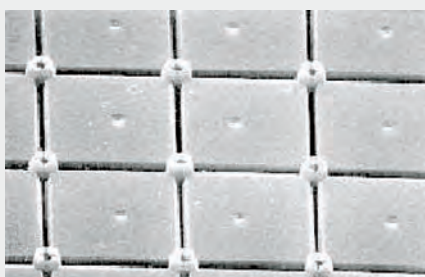
Bild 14b: LCoS, Sicht auf Pixel, Spiegel Die Ansteuerelektronik liegt darunter
