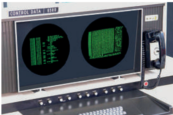
Die Konsole der CD 6500 mit den beiden CRT-Röhren mit Punkt- oder Zeichenauflösung
