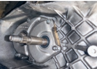
Abbildung 6: Getriebedeckel mit gelösten Schrauben
