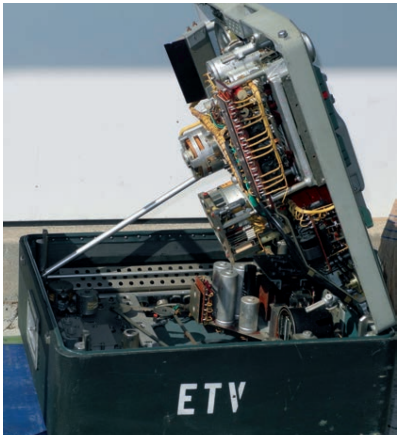
Aufklappbares Laufwerk und betriebsmässig zugängliche Wartungsorgane
