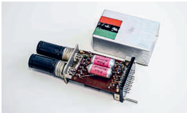
Bild F: Die ERMETH war aus rund 2000 modularen Steckeinheiten, als Kannen bezeichnet, aufgebaut, welche von der Firma Hasler AG in Bern mit total 23 unterschiedlichen Bestückungen produziert wurden. Unter den schwarzen Abdeckungen befinden sich meistens Doppeltrioden-Röhren.
