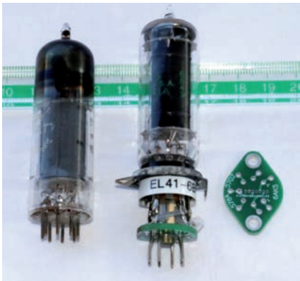
Bild 4: EL41 und Adapter mit 6BK5, Steckerplättchen
