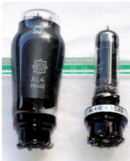
Bild 6: AL4 und Adapter mit 5CZ5
