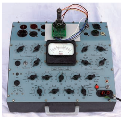
Bild 5: METRIX Röhrenmessgerät mit Tastadapler
