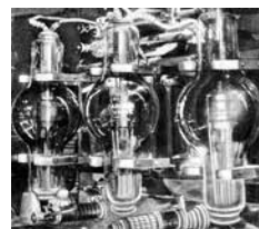
Luftgekühlte Röhren, vermutlich aus der Modulationsstufe von Beromünster 1)
