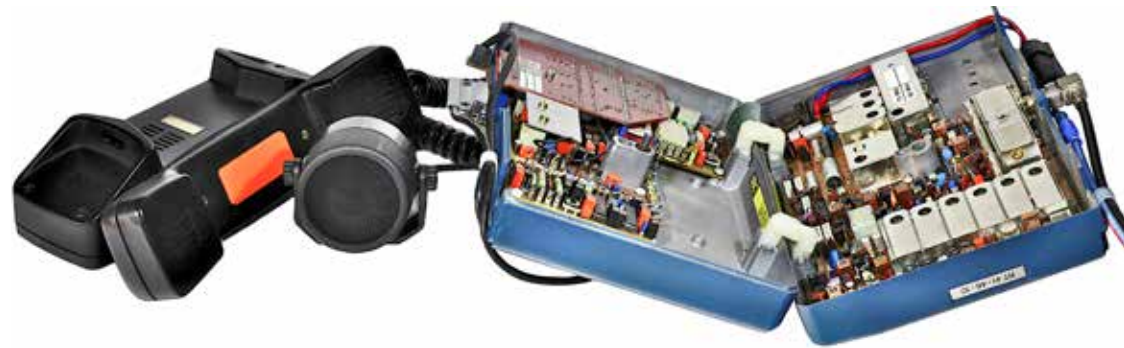
Bild 1: RT41-460 mit Selektivruf-NF, aufgeklappt, Mikrotelefon und Lautsprecher
