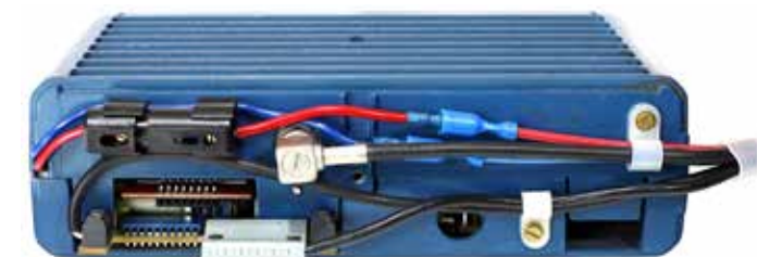
Bild 4: Anschlüsse und Kabel unter dem Schutzdeckel
