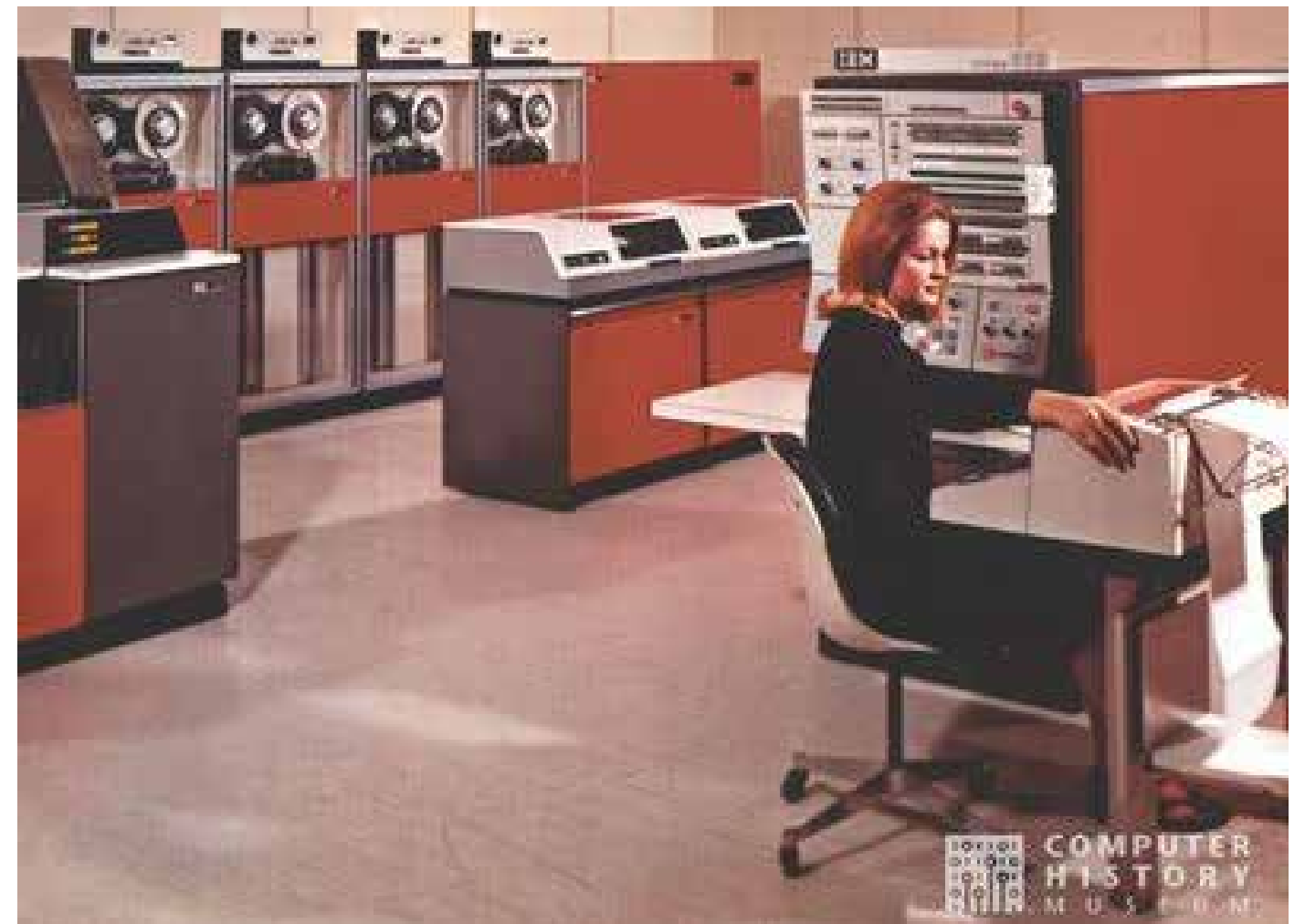
IBM S/360 Anlage mit Bedienerkonsole, Zentraleinheit, Disk- und Tape-Stationen
