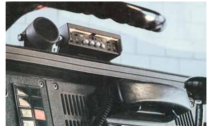
Bild 3: RT41 Bediengerät mit Codeschaltern, Lautsprecher und Mikrotel im Fahrzeug ©ABB
