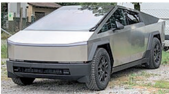
Tesla Cybertruck. L 5.6 m B 2.4 m, Karosserie aus 3 mm dickem Stahl. 3.1 Tonnen
