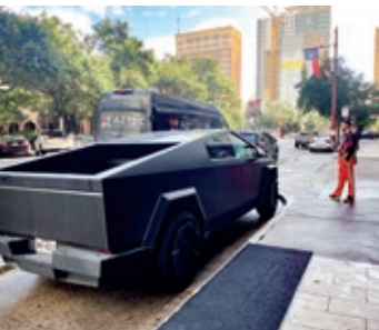
Tesla Cybertruck. L 5.6 m B 2.4 m, Karosserie aus 3 mm dickem Stahl. 3.1 Tonnen
