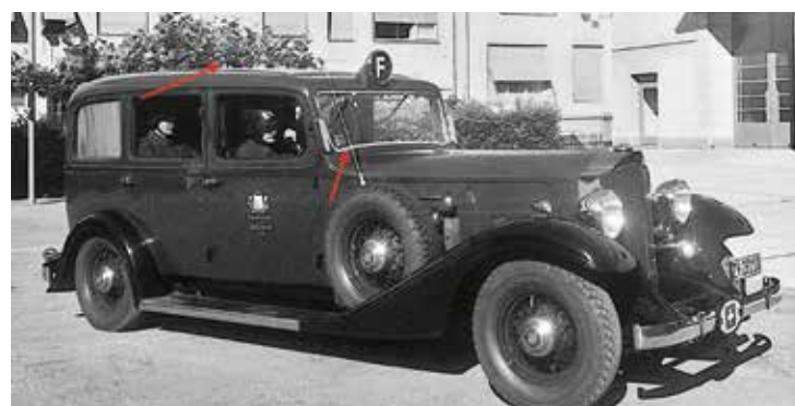
Bild 1: Feuerwehrauto mit Stabantenne (S, VHF) und flacher Dachantenne (E, KW)
