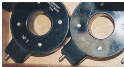
Empfangs-Steckspulen N° 3, 5, 10, 15, 20 für 27-43; 40-60; 55-80; 70-100 m Band
