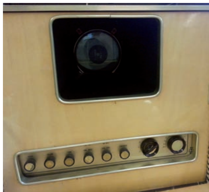
Bild 9b: Blick auf Projektionsröhre mit Schmidt-Optik, schwarzweiss
