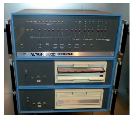
Altair 8800 Heimcomputer, Bausatz Hersteller: MITS Prozessor: Intel 8080 Arbeitsspeicher: 256 Byte (auf 64 KB erweiterbar) Datenträger: Lochstreifen Compact Cassette, Diskette Betriebssystem: Altair BASIC, CP/M-80
