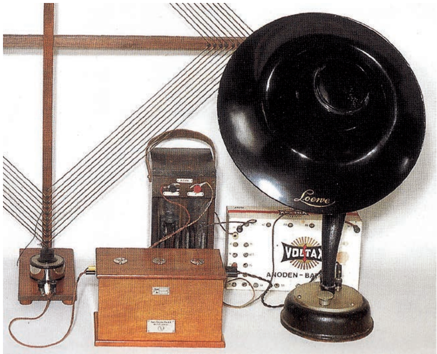
Loewe N.F. 333 als Rundfunkempfänger mit abstimmbarer Rahmenantenne Blue-Box-Prinzip [Bild: Dipl.-Ing. Günter F. Abele, Die dynamische Chronik, 3. Kapitel Teil 2]
