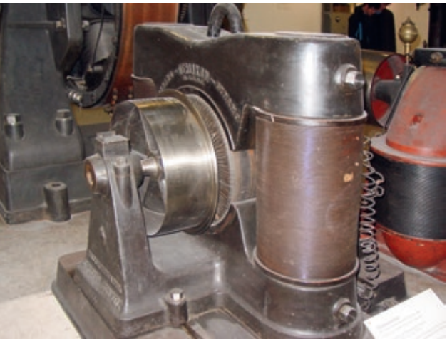
Generator für die Energieübertragung Kriegstetten-Solothurn
