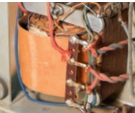
Der Stromversorgungstransformator ist mit 2 Schrauben und 2 Halterungen befestigt, seine Magnetbleche haben keine Löcher
