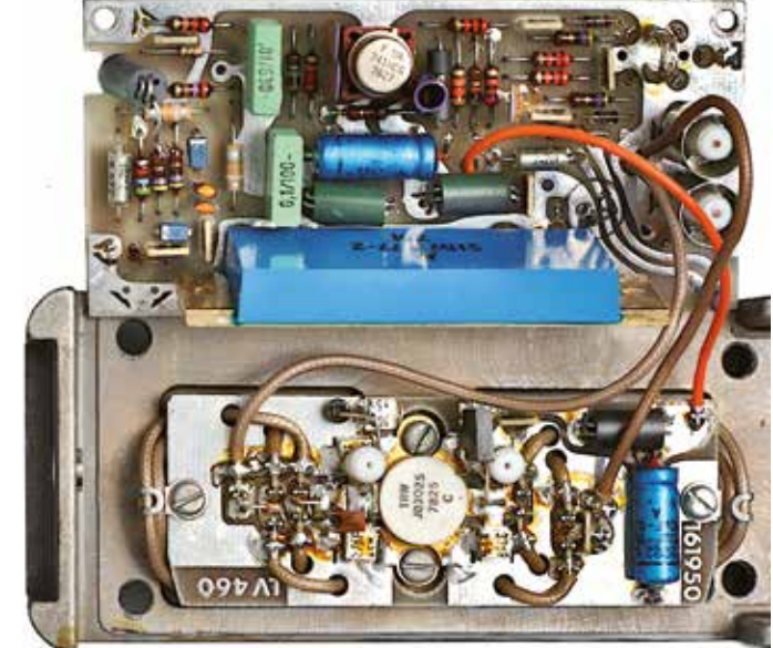
Bild 9: LE-460 (ohne Gehäuse, oben) und LV-460 (unten). Beim LE links Regelschaltung, rechts Richtkoppler und Oberwellenfilter, blau 6W Hybridmodul.
