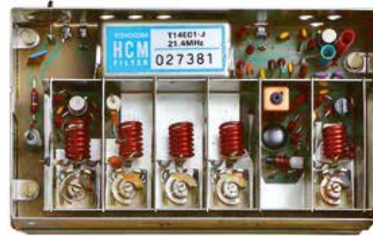
Bild 6: RF-160-1, Unten: Vorstufe und Filter: symm. Mischer: LO-Verdoppler, oben Quarzfilter.
