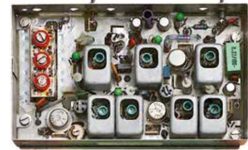
Bild 8: SV-460, Unten: Ausgangsfilter und Treiber: Vervielfacher, Mitte: Modulator.
