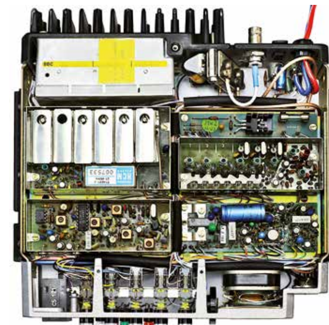
Bild 4: Mobilfunkgerät RT31-46, Empfängerseite. Links LE, HF*, ZF*, rechts UP, GE*, NF (* = ohne Abschirmdeckel).
