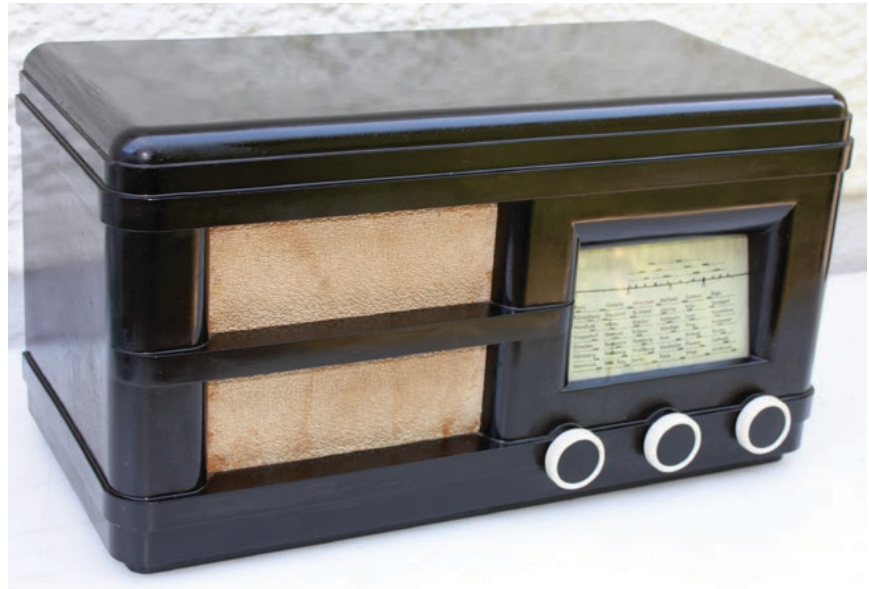
Radio-Union Typ 1 W, Bj. 1936/37. Der Empfänger mit Pressstoffgehäuse hat eine von hinten durchleuchtete Grosssichtskala. Der linke Einstellknopf betätigt den Netzschalter und den Differentialdrehkondensator zur Lautstärkeeinstellung. In der Mitte ist der Abstimmknopf und rechts die Rückkopplung.
