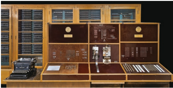
Die Z4 ist ein Relaisrechner und wurde 1944 in Göttingen fertiggestellt.
