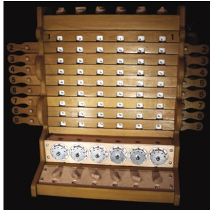
Gesamtansicht der Schickard -Rechenmaschine als Nachbau. Unten das Addier- und Subtraktionswerk, oben die Multiplikationsvorrichtung nach dem System der Napier -Stäbchen
