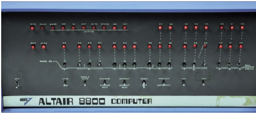
Frontplatte ALTAIR 8800 mit Schalter und LED (I/O)
