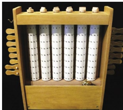
Das Innenleben von hinten: Die sechs Walzen mit den Einmaleins-Kolonnen sind gut erkennbar
