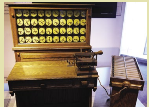
Ein vollständiges Hollerith-System mit Leser (v.), Sortierer (r.) und Zählwerk (h.) aus dem Jahr 1890
