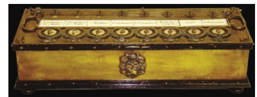
Die 8-stellige Pascaline wurde im Jahr 1647 gebaut. Es wurden rund 50 Exemplare hergestellt, wovon heute noch 9 existieren. Auch Kilometerzähler arbeiteten nach dem Konstruktionsprinzip der Pascaline
