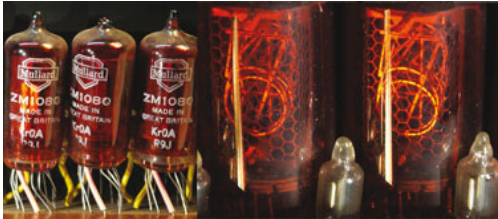
Die Tischrechner der ersten Generation waren in diskreter Bauweise, d.h. mit Transistoren, Dioden, Widerständen und Kondensatoren aufgebaut. Zur Anzeige kamen "Nixie-Röhren" (Bild Anzeige ANITA 1011, links Röhren, rechts Innenleben). In dieser Röhre waren die Zahlen 0 bis 9 als Drahtkathode aufgebaut, welcher bei einer Ansteuerung das umgebende Plasma zum Leuchten bringt. Die Lampe zwischen den Röhren diente zur Anzeige der Dezimalstelle.
