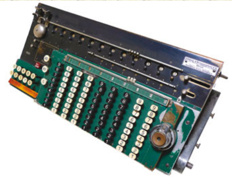
Sprossenradmaschine des US-Herstellers Marchant aus dem Jahre 1915 mit einem ausgelagerten elektrischen Antrieb auf der Seite.
