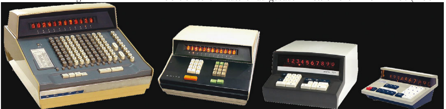
Dieses Bild zeigt die Entwicklung der ANITA-Tischrechner-Familie sehr schön auf. Links die Mark VIII (1961) mit Volltastatur und elektronischen Komponenten wie Radioröhren und Kaltkathoden, dann die Mark 12 (1966) mit gleichem Innenleben aber mit Zehnertastatur. Daneben die ANITA 1011 (1969), aufgebaut mit diskreter Logik und mit einigen integrierten Schaltungen (ICs). Ganz rechts dann das kleinste Modell ANITA 1000 LSI (1971) nur noch mit ICs bestückt. Alle Modelle führen die gleichen Funktionen aus und verwenden die Nixie-Röhre zur Anzeige (10 Stellen).
