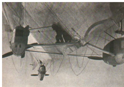
Die beiden seitlichen Motorgondeln sind über einen Laufsteg erreichbar
