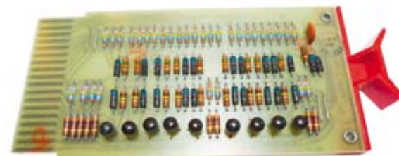
Dieses Flip-Chip-Modul aus einer PDP-8 der ersten Generation ist in der Grösse normiert (62x127 mm) und verfügt über 18 Anschlussstellen. Dieses Modul, ein Quadraplop, ist mit der DTL-Logik aufgebaut mit 9 Transistoren, 32 Dioden, 50 Widerständen und 1 Kondensator. Es kamen auch Module mit doppelter oder vierfacher Grösse zum Einsatz
