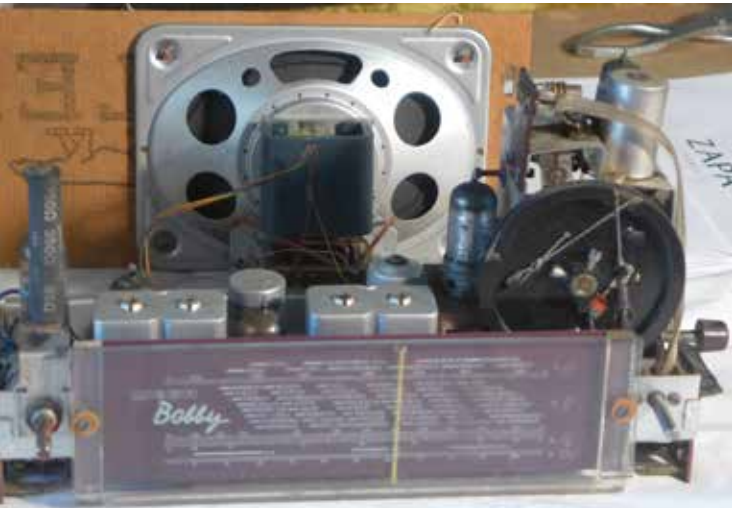
Abb. 3 Auf der Rückseite ist ein grosser Lautsprecher in rechteckiger Form 180 × 130 mm platziert.
