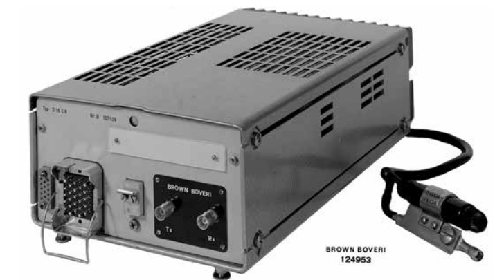
Bild 2: RT18 5W-Sendeempfänger, Basisgerät
