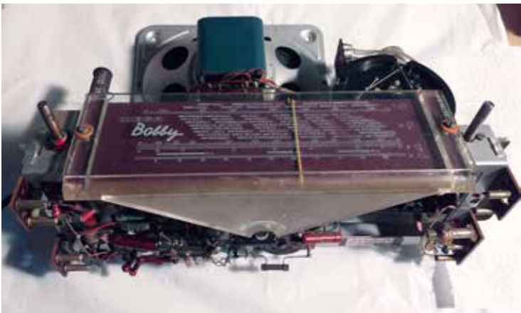
Abb. 4 Ein lichtleitendes Plexiglas vom Leuchtmittel unter dem Rahmen in der Mitte nach innen und über die gesamte Breite des Bildschirms, eine innovative Verbesserung!
