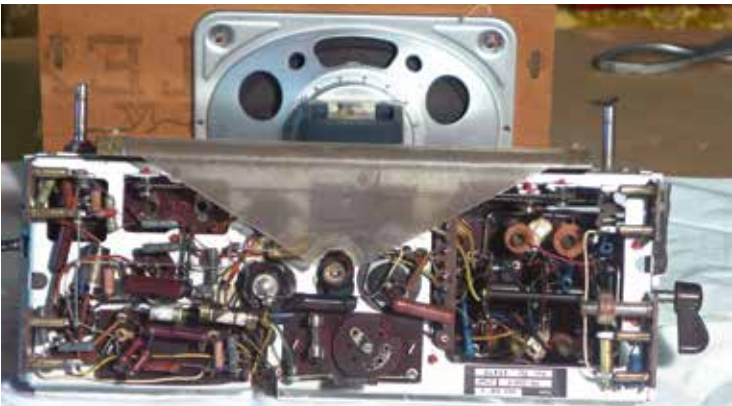
Abb. 5 Kompakte Elektronik, 305 × 125 mm grosses Chassis, von dem wir das lichtleitende Plexiglas über die gesamte Breite der Skala sehen können.
