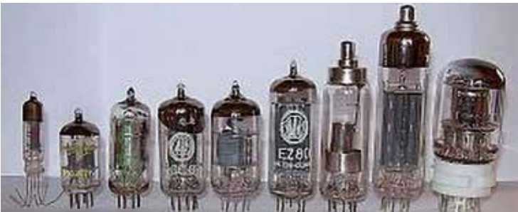
Auswahl von Elektronikröhren Stefan Riepl © (Quark48),commons.wikimedia.org
