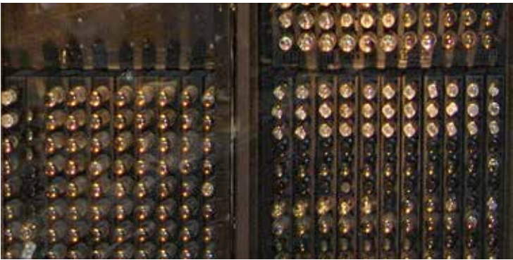
Elektronenröhren bei ENIAC Penn 2. Commons.wikimedia.org
