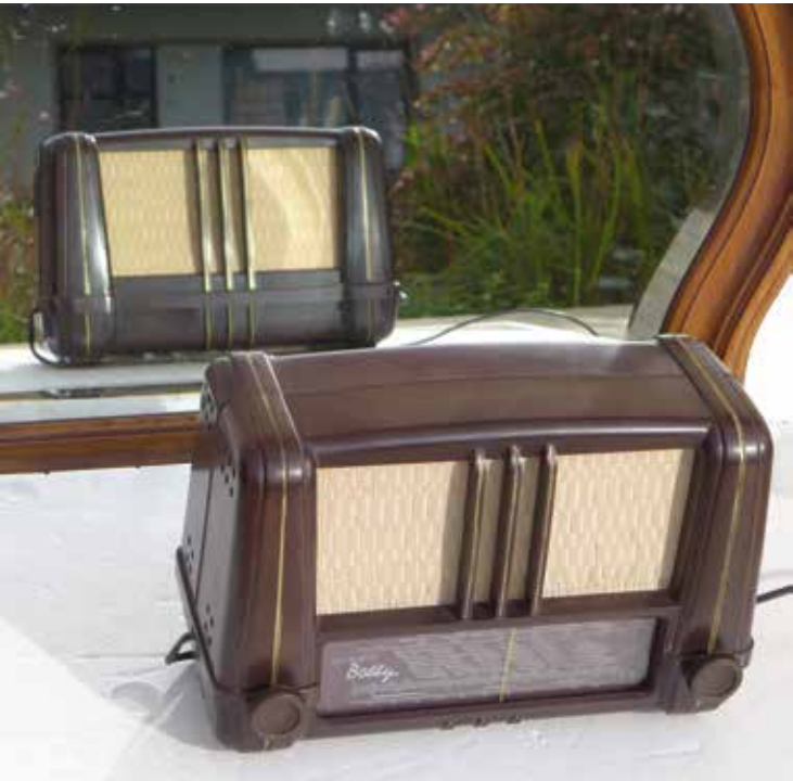
Abb. 6 Bobby-Radio von WEGA, dessen Rückseite im Spiegel zu sehen ist. Seine Röhren EC92 + ECH42 + EAF42 + PCL81 + AZ41.
