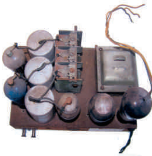
Das total verrostete Chassis, Kabel mit brüchiger Gummi-Isolation
