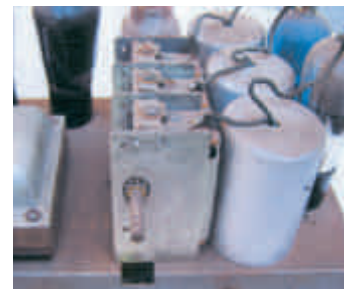
Der Drehkondensator war in Ordnung, bei gut ausgerichtetem Plattenabstand, doch es fehlte die ganze Triebmechanik.
