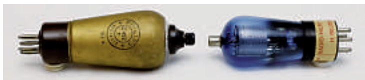
Bild 3: Frühe AC-Tetroden: Philips E452T und Arcturus 24 (das blaue Glas ist nur Deko!)
