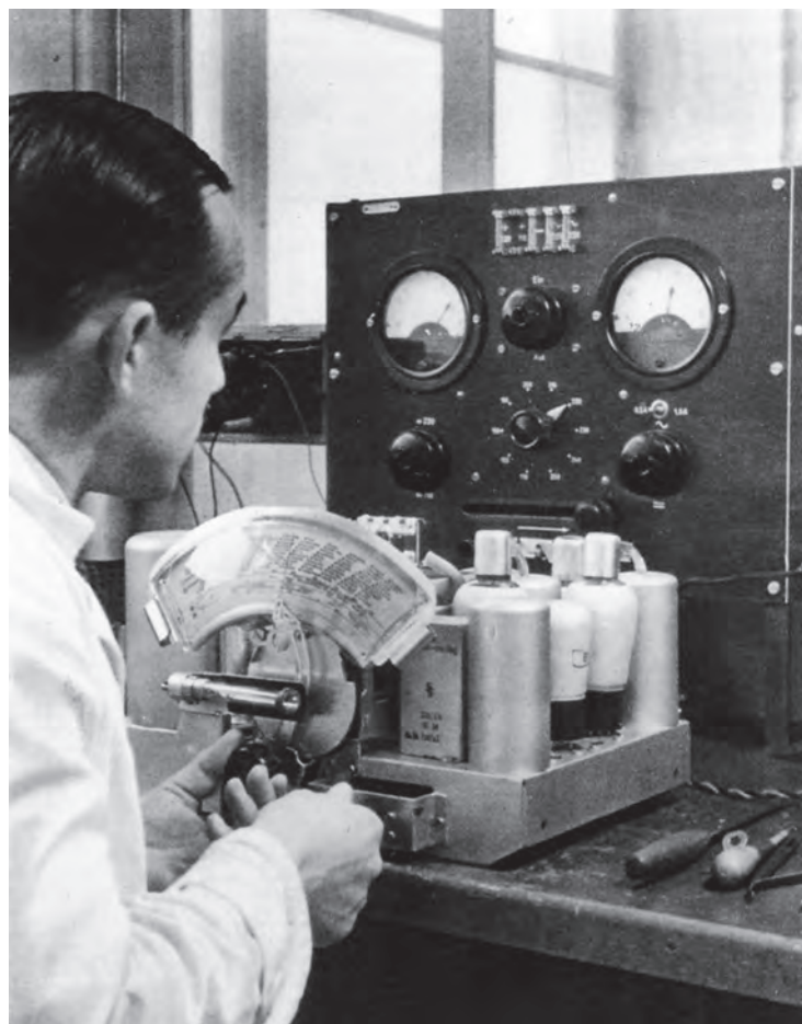
Werkseinstellung der abgestimmten Schaltkreise des SABA 521 WL 1933
