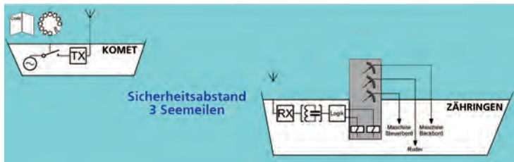
(Vermutetes) Blockschaltbild der Fernsteuerung
