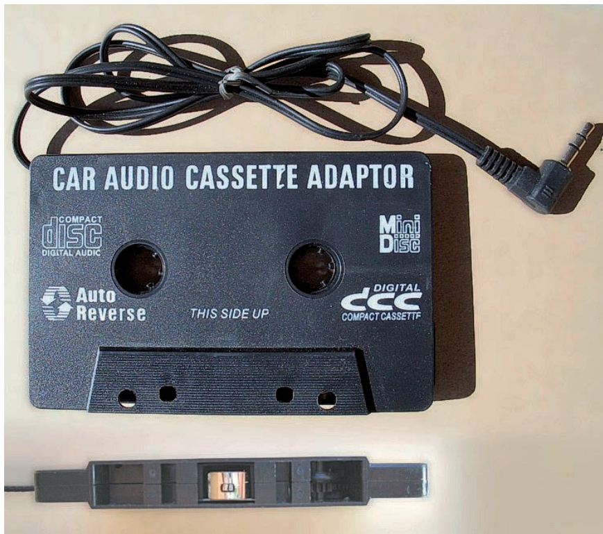
Die Verbindung des DAB+ Empfängers zum bestehenden Autoradio lässt sich qualitativ akzeptabel mit einem Kassettenadapter lösen
