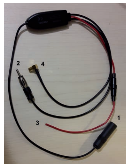
Ein Antennensplitter ermöglicht DAB+ Empfang ohne besonderes Empfangsgerät und Scheibenantenne
