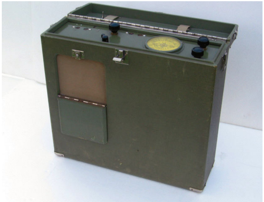
DOK Bj. 1936 mit Barometerskala und Schutzklappe vor dem Lautsprecher. Im Deckel befinden sich Spannbänder, die die auf Haspeln aufgewickelten Litzen für Antenne und Gegengewicht halten sollten
