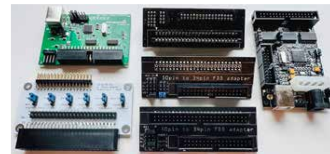
Verschiedene Geräte und Adapter zum Lesen von 8-Zoll-Disketten
