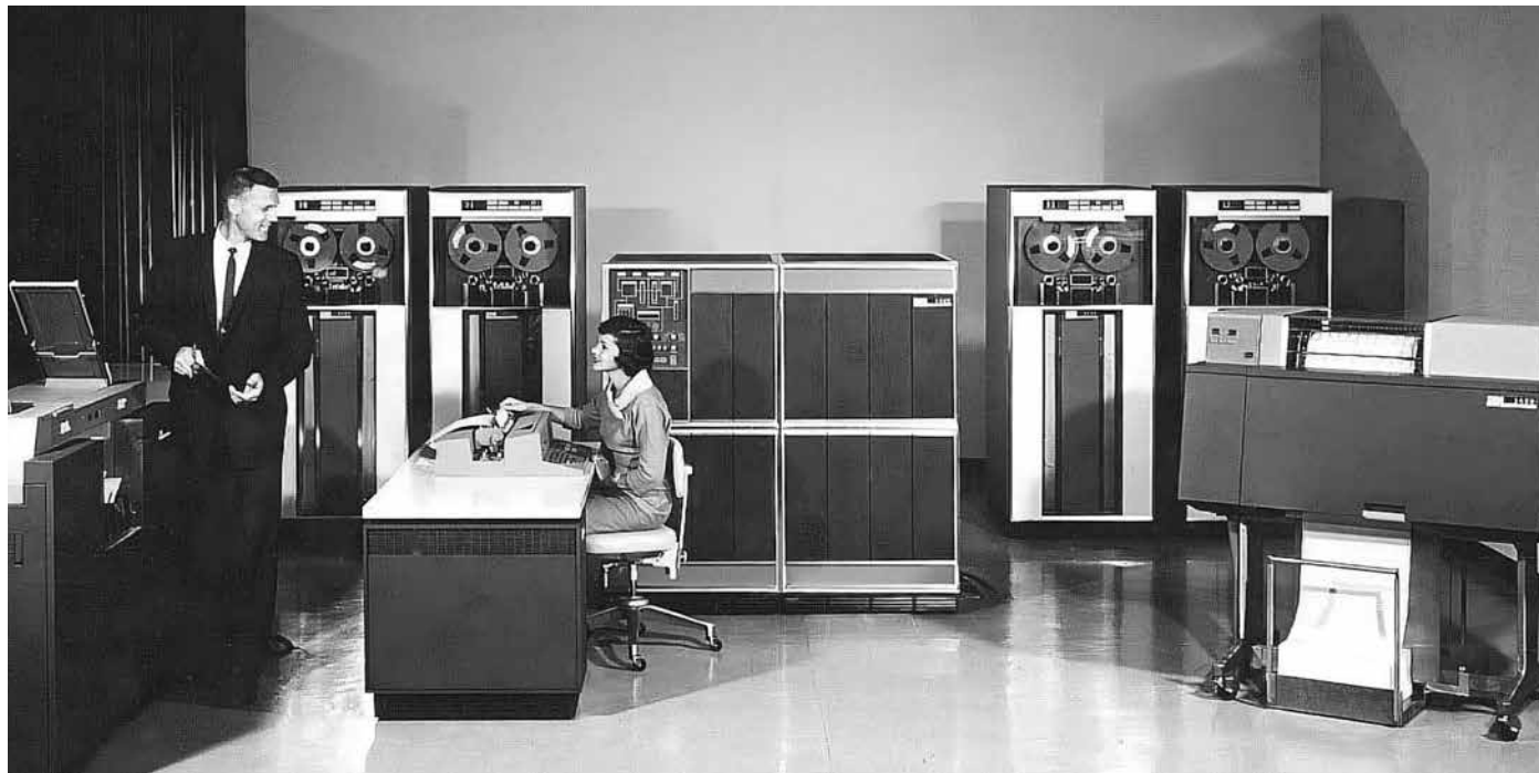
Mann und Frau bedienen eine 1401 (Kartenleser, Operatorkonsole, Drucker, Prozessor und 4 Bändeinheiten). © Pinterest
