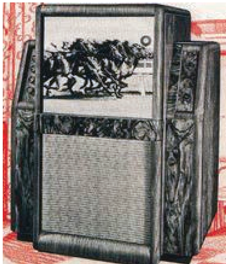
Bild 6b: Scophony Apparat von 1938 mit rotierenden Spiegeln Bildgrösse ca. 60cm
