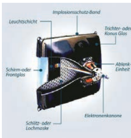
Bild 3b: Schnitt durch eine Farbbildröhre
