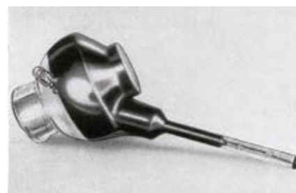
Bild 4: Projektionsröhre von 1938, 80kV Anodenspannung, 25cm Bilddiagonale
